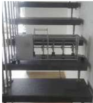
Schallschutzprüfung Sound insulation test
